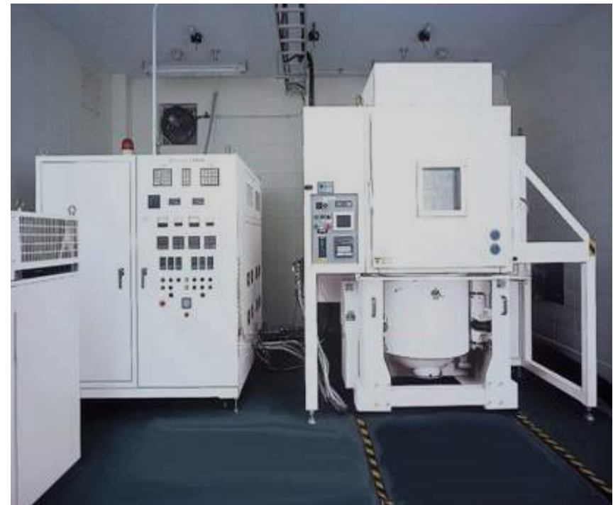
オールウェザーシミュレーター (振動・温度・湿度・作動装置)
